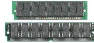
SIMM-Module in der 30- und 72-poligen Ausführung mit Datenbreiten von 8 und 32 Bit.
